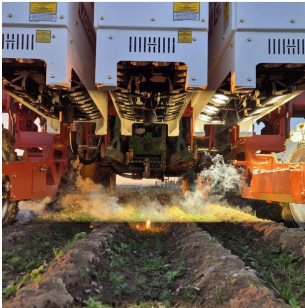
図表6：Carbon Robotics社のレーザー除草機
