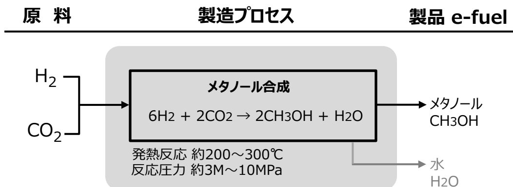
図表4：e-メタノールの基本的な製造プロセス
