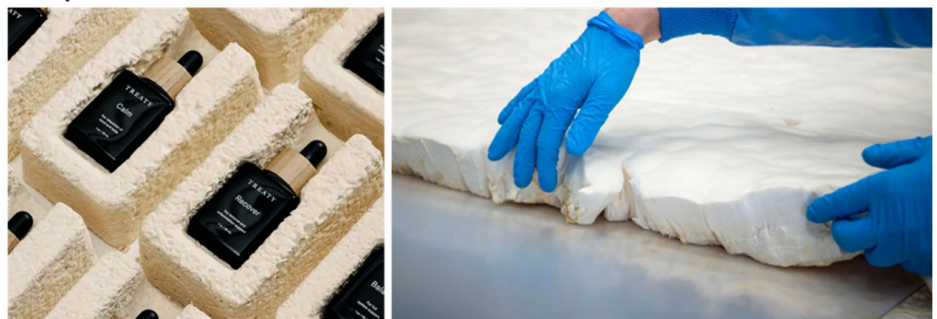
図表5 Ecovative Design社が開発した菌糸体を利用したパッケージ(左)とAirMycelium技術により培養された菌糸体(右)
