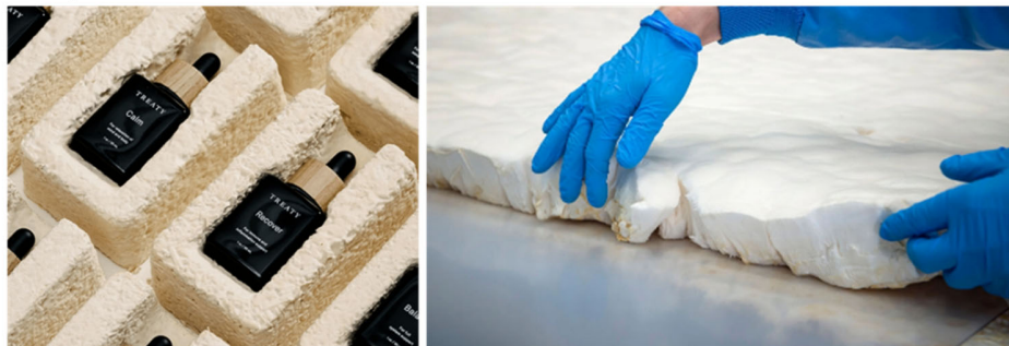
図表5 Ecovative Design社が開発した菌糸体を利用したパッケージ(左)とAirMycelium技術により培養された菌糸体(右)
