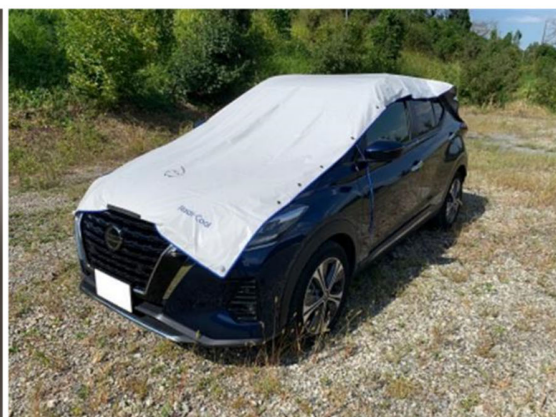
図表3 放射冷却メタマテリアルを利用したサンシェード（左）とハーフボディカバー（右）
