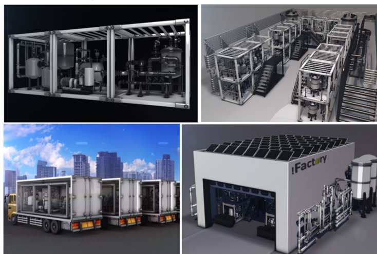
図表5 iFactory が目指す再構成可能な連続生産設備
