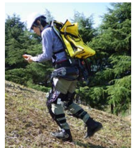
ATOUN社は、住友林業、森林研究・整備機構 森林総合研究所、および奈良先端科学技術大学院大学と、傾斜面の歩行などを支援する林業用パワードスーツの共同開発にも取り組んでいる
