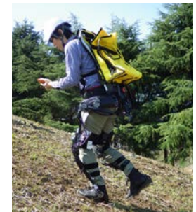
ATOUN社は、住友林業、森林研究・整備機構 森林総合研究所、および奈良先端科学技術大学院大学と、傾斜面の歩行などを支援する林業用パワードスーツの共同開発にも取り組んでいる
