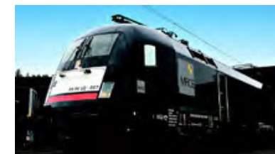
欧州でリース展開するシーメンス製電気機関車
