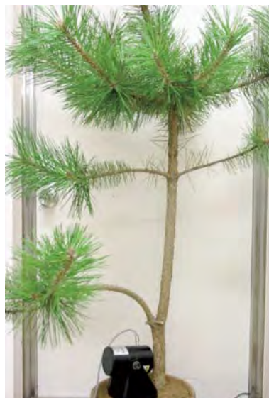
害虫の行動を阻害するために、振動発生装置を設置したマツの苗木
