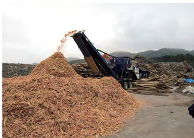
分別収集された震災廃木材のチップ化(岩手県山田町)
