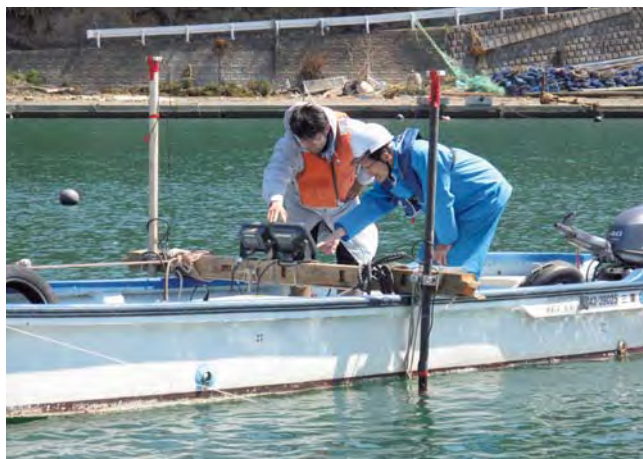
サイドスキャンソナーを使用し、海底に沈んでいるガレキを探索
