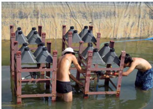
チャンタブリのプラパ大学内の試験池において液膜式酸素供給装置を設置している状況
