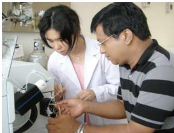
ICP-MS(誘導結合プラズマ質量分析装置)を用いて、実際に飲用水の重金属濃度を測定しているところ
