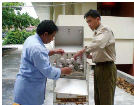
インドネシア・ガジャマダ大学の屋上に設置した粉塵サンプラー
