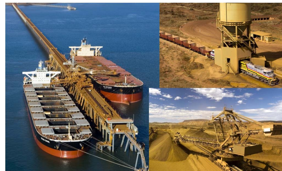
ローブリバーJ/Vの操業。採掘された鉄鉱石は貯蔵場(写真右下)を経て貨車に積み込まれ(写真右上)、約400km先の専用港(写真左)まで輸送される
