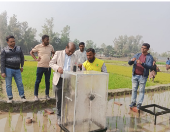
プロジェクト圃場でのガスのサンプリング
