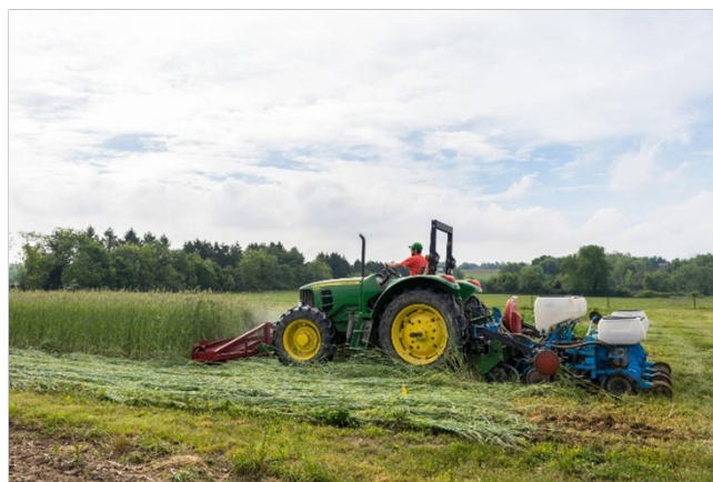
【図表5】ロデール研究所のローラークリンパー
