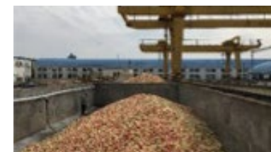
水流により工場内へ流れるリンゴ果実の搬入プール
