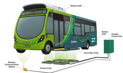
非接触充電EVバスの電磁誘導方式
