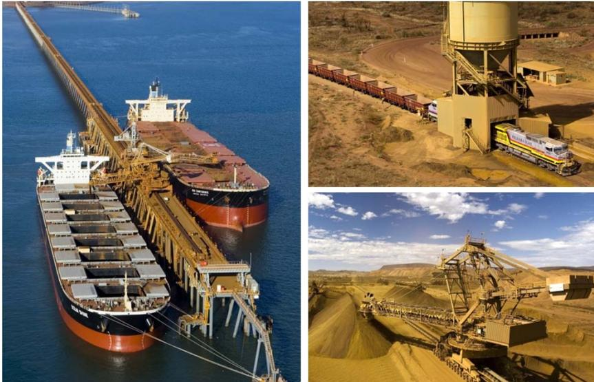
豪州ローブリバーJ/Vの操業。採掘された鉄鉱石は貯蔵場(写真右下)を経て貨車に積込まれ(写真右上)、約400km先の専用港(写真左)まで輸送される。
