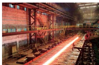
サイアムヤマト・スティール社の熱間圧延ライン(タイ)
